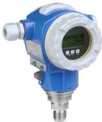
Cerabar PMP71 数字压力测量变送器采用金属膜片，主要用于过程工业，可测量液体和气体的压力、液位、体积和质量。PMP71 专为高压测量场合设计，最高工作压力可达 700ba。带快速设定功能，量程可调。设计符合 IEC61508 标准，满足 SIL2/3 功能安全要求。提供 MID 计量认证证书，适用于计量交接。
