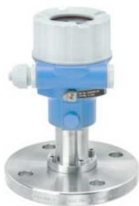
Cerabar PMC51 数字压力变送器采用无油电容式陶瓷测量元件，主要用于过程工业和卫生行业，可测量液体和气体的压力、液位、体积和质量。PMC51 使用耐真空陶瓷膜片，确保测量系统高度安全。量程可调，快速设定功能使调试更简单，节省成本和时间。设计符合 IEC61508 和 IEC 61511 标准，满足 SIL2 功能安全要求。
