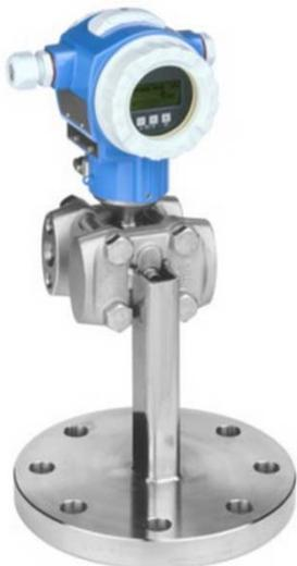
Deltabar FMD77 差压变送器采用金属传感器，单面隔膜密封，主要用于过程工业中液位的连续测量。内置 HistoROM 数据模块，方便过程和设备参数管理。符合 IEC 61508 标准，满足 SIL3 功能安全要求。
