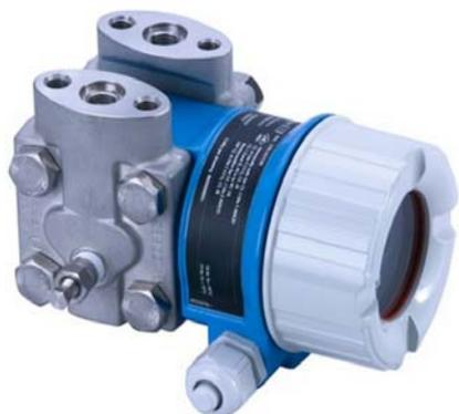
Deltabar PMD55 差压变送器采用压阻式传感器和焊接式金属膜片，主要用于过程工业或环保行业内液体、蒸汽和气体的差压测量。测量范围可调，快速设定简化调试过程，降低成本，节约时间。符合 IEC61508/IEC61511 标准，满足 SIL3 安全要求。
