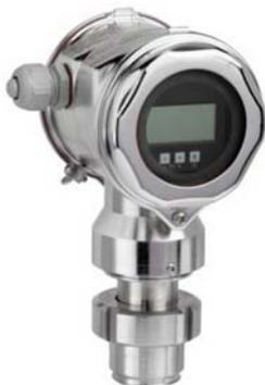
Deltapilot FMB70 采用抗冷凝 CONTITE 测量元件和双腔室外壳，主要用于过程工业和卫生行业，测量敞开式或封闭式容器中液体或浆料介质的液位，测量不受泡沫影响。内置 HistoROM 数据模块，方便管理过程和设备参数。设计符合 IEC 61508 标准，满足 SIL3 功能安全要求。
