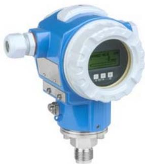
Cerabar PMC71 数字式压力变送器采用无油电容式陶瓷测量元件，主要用于过程工业和卫生行业，可测量液体和气体的压力、液位、体积和质量。PMC71 使用耐真空陶瓷膜片，确保测量系统高度安全。量程可调，快速设定功能使调试更简单，节省成本和时间。设计符合 IEC61508 标准，满足 SIL2/3 功能安全要求。
