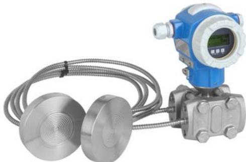
Deltabar FMD78 差压变送器采用金属传感器，带双毛细管膜片密封，主要用于过程工业和卫生行业内液体、气体、蒸汽和粉尘的差压连续测量。内置 HistoROM 数据模块，方便过程和设备参数管理。符合 IEC61508 标准，满足 SIL3 安全功能要求。
