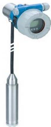
带悬挂固定夹的缆式 Deltapilot FMB53 采用 Contite 测量元件，主要用于环保行业，可测量敞开式或密闭容器中液体或浆料介质的液位，测量不受泡沫影响。设计符合 IEC61508 标准，满足 SIL2 功能安全要求
