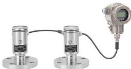
电子差压变送器 Deltabar FMD71 是差压系统，由两个传感器和一台变送器组成，用于带压罐或蒸馏塔/蒸发器中液体的液位、体积或质量测量。一个传感器用于静压测量(高压)，另一个传感器用于顶部压力测量(低压)。基于上述两个数字量压力值，变送器计算得出液位值(电子差压)。电子差压测量系统消除了传统差压测量中出现的问题。
