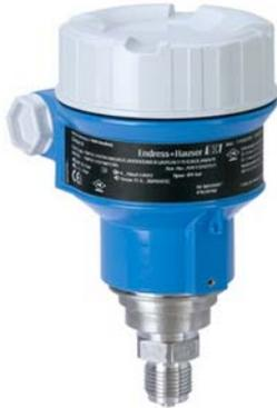
Cerabar PMP51 数字式压力变送器采用金属膜片，主要用于过程工业和卫生行业液体或气体的压力、液位、体积和质量测量。PMP51 专为高压测量场合设计，最高工作压力可达 400bar。量程可调，快速设定功能节省成本和时间。符合 IEC61508 和 IEC 61511 标准，满足 SIL2 功能安全要求。
