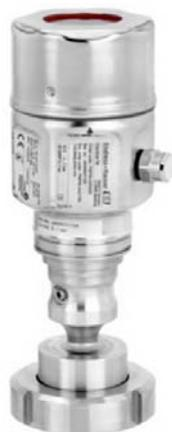
Cerabar PMP55 数字式压力变送器采用金属膜片密封，主要用于过程工业和卫生行业，测量液体的压力、液位、体积和质量。PMP55 专为高压和极端高温测量场合设计，最高工作温度可达 400 °C(-94 ~ 750°F)。量程可调，快速设定功能节省成本和时间。符合 IEC61508 和 IEC 61511 标准，满足 SIL2 功能安全要求。
