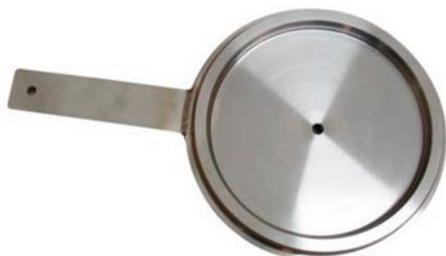
Deltatop DR61S 是差压流量测量系统中的取压元件如文丘里管、喷嘴、孔板，和 Deltabar 差压变送器配套使用，组成差压流量测量系统。节流孔板安装在专用于减压或限流的管道中。通常，节流孔板与孔板十分相似；但是，进行流量测量时节流孔板无需另外的变送器。
