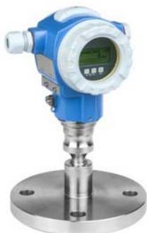
Cerabar PMP75 数字压力变送器采用金属膜片密封，主要用于过程工业和卫生行业，可用于测量液体或气体的压力、液位、体积和质量。变送器适用于高温、高压场合，温度范围可从-70 至 400 °C。测量范围可调，可快速设置，节省成本和时间。设计符合 IEC61508 标准 SIL2/3 功能安全系统。
