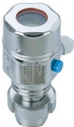
Deltapilot FMB50 一体化变送器采用抗冷凝的 Contite 测量元件，主要用于过程工业和卫生行业，用于测量敞开式或封闭式容器中液体或浆料介质的液位，测量不受泡沫影响，满足 SIL2 功能安全要求。
