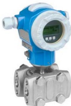
Deltabar PMD75 差压变送器采用压阻式传感器，焊接式金属膜片，主要用于过程工业和环保行业内液体、蒸汽和气体的差压连续测量。3 键式操作，调试和使用简单可靠。内置 HistoROM 数据模块，方便过程和参数管理。符合 IEC61508 标准，满足 SIL3 功能安全要求。
