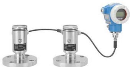
Deltabar FMD72 电子式差压测量系统用于测量压力容器或蒸馏塔/蒸发器中液体的压力、液位、体积或质量。高压侧传感器（HP）测量液体静压，低压侧传感器（LP）测量顶部压力，变送器根据传感器输入值计算液位。电子远传差压液位测量系统消除了传统差压测量遇到的难题。
