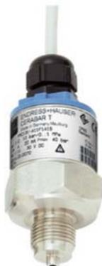
Cerabar PMC131 是一款价格诱人的压力变送器，采用无油电容式陶瓷传感器，用于绝压和表压测量。一体化结构具备如下特点：传感器直接接触介质，无膜片密封；高过载能力/耐真空；航空插头连接，IP65 防护等级。
