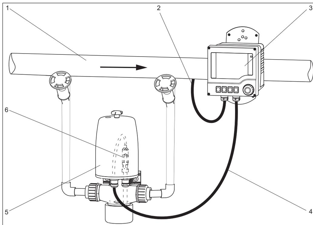
图 1: 测量系统的结构示意图 (旁通管中安装)
