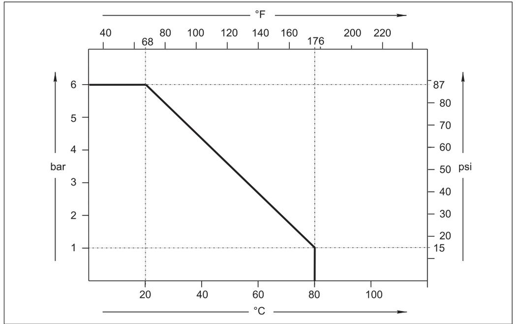
图 5: 压力 - 温度曲线示意图
